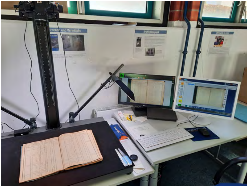
Alles auf einen Blick: Archivgut (auf dem Scantisch), Vorschau (linker Bildschirm) und fertiges Digitalisat (rechter Bildschirm).
